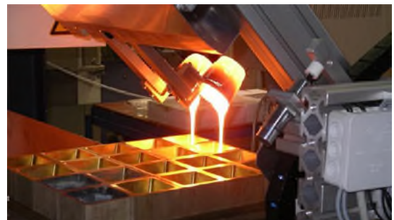
© Fraunhofer ISC, Würzburg, B. Durchgang, Glass-Screening-Anlage zur automatisierten Glasschmelze für kleine Probenmengen
