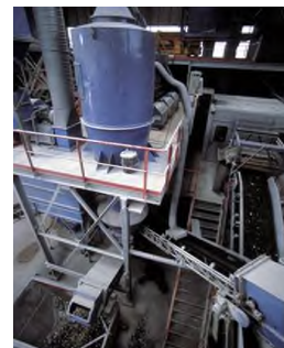
In der Aufbereitungsanlage wird das Glas von Abfall befreit, damit neues Glas hergestellt werden kann.
